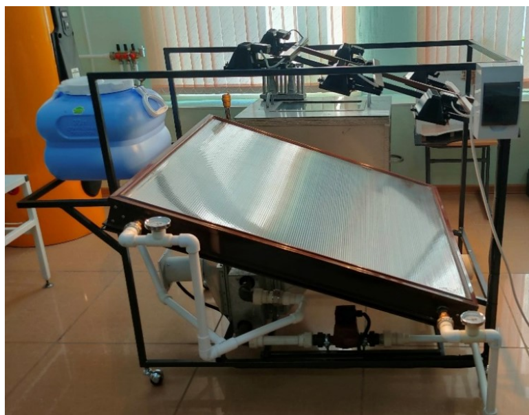
Рис. Лабораторный стенд «Использование гелионагрева воздуха в системе воздушного отопления»
