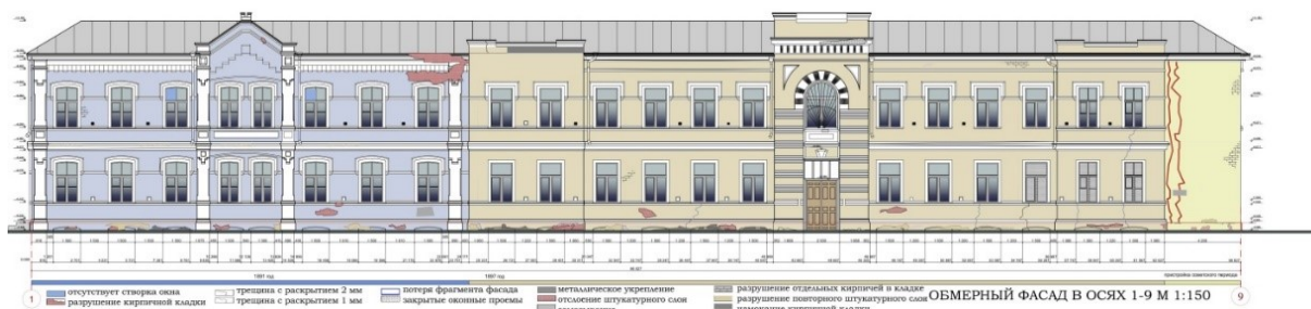
Рис. 1. Фасад с выявленными дефектами
