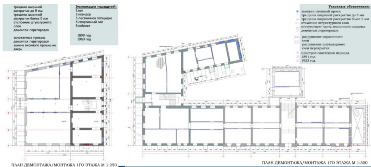
Рис. 2. Планы дефектных ведомостей
