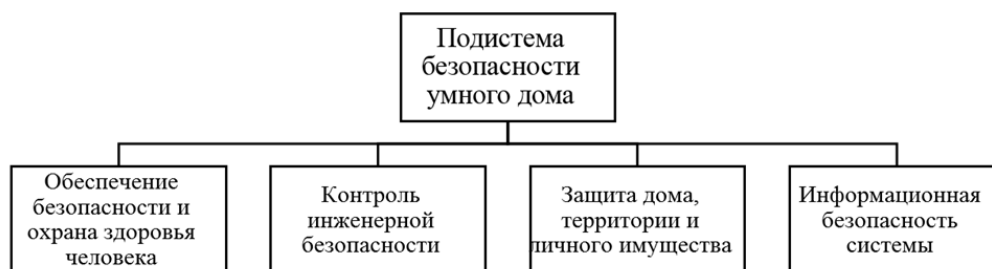
Рис. 3. Классификация направлений подсистемы безопасности умного дома
