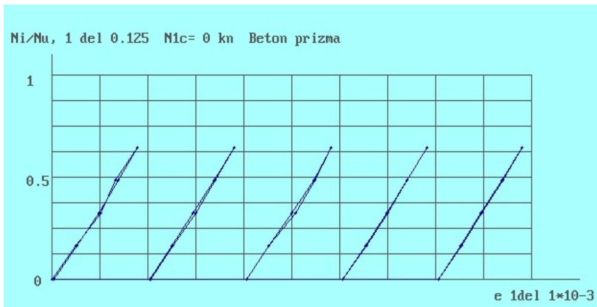
Рис. 1. Графики ( N_i/N_u - e ) (уровень нагрузки – относительная деформация) бетонной призмы, подвергавшейся предварительным нагрузкам.
