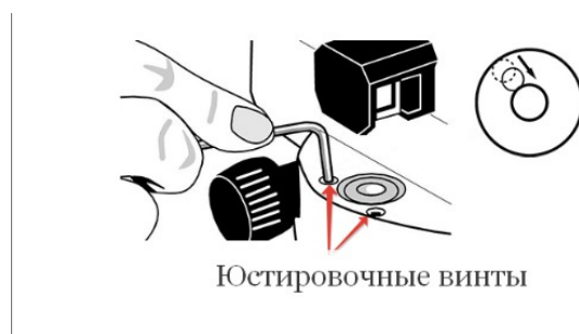
Рис. 3. Круглый уровень нивелира. Пример юстировки.
